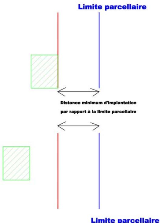
Implantation des constructions et installation par rapport à la limite parcellaire  $\geq 12$  m
